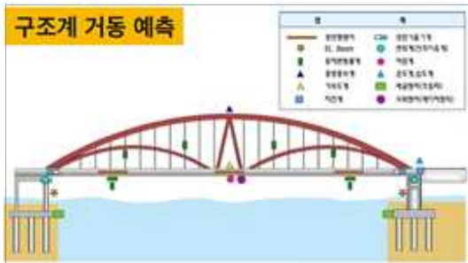
<센서 활용 실시간 교량계측 모니터링 예시>
